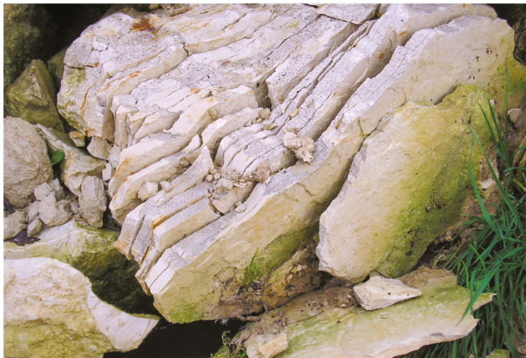
Photographie 9: Calcaire biodétritique gélif (Source : Eiffage)
