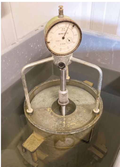
Photographie 3: Moule CBR immergé (Source : Eiffage)
