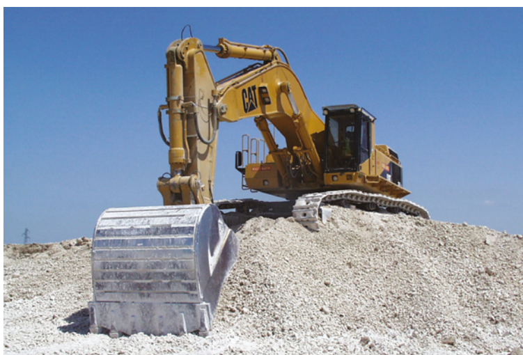
Photographie 12: Extraction à la pelle en rétro pour extraction frontale (Source: SCSNE)
