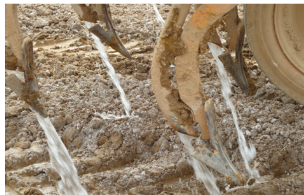
Photographies 14 et 15 : Humidification par enfouisseuse (Source : SCSNE)
