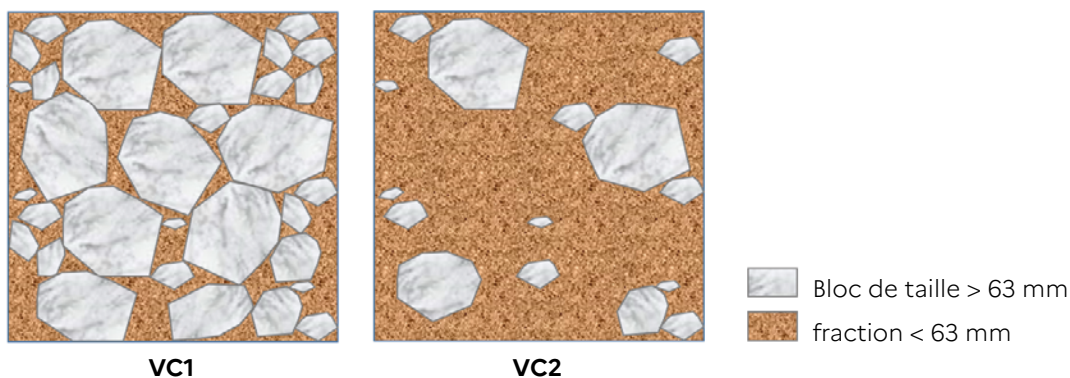
Figure 4 : Illustration des différences entre un sol VC1 et un sol VC2
